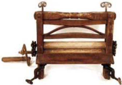
Handbetriebene Mangel, die anhand von Schraubzwingen auf einem Behälter oder einer Waschmaschine befestigt wurde. Der auf die Wäsche ausgeübte Druck wird durch zwei Flügelmuttern geregelt. Diese befinden sich auf der rechten und der linken Seite eines Holzgestells, unter dem sich ein Metallbogen befindet.
